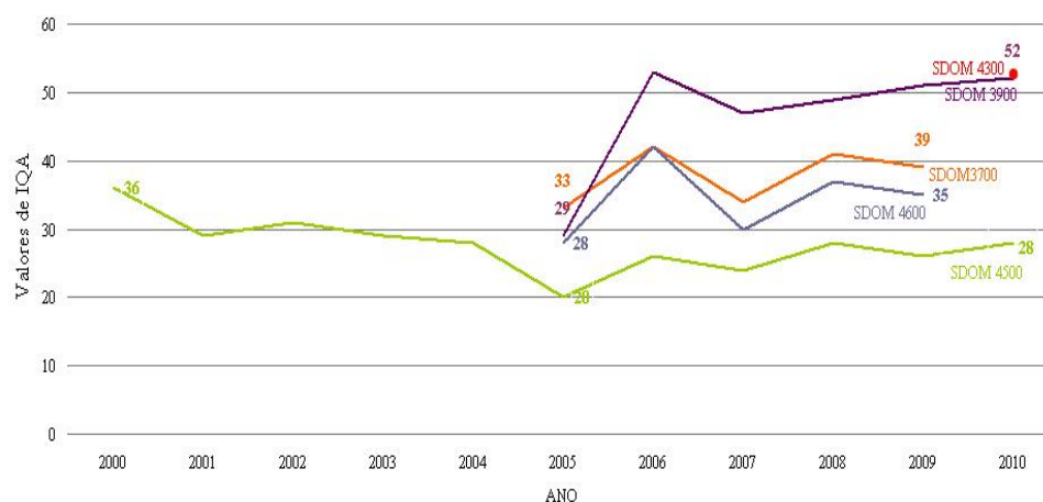
Figura 6 Valores do IQA nos anos 2000 a 2010 nos pontos monitorados pela CESTESB ao longo do Rio São Domingos e suas classificações quanto à qualidade da água.
